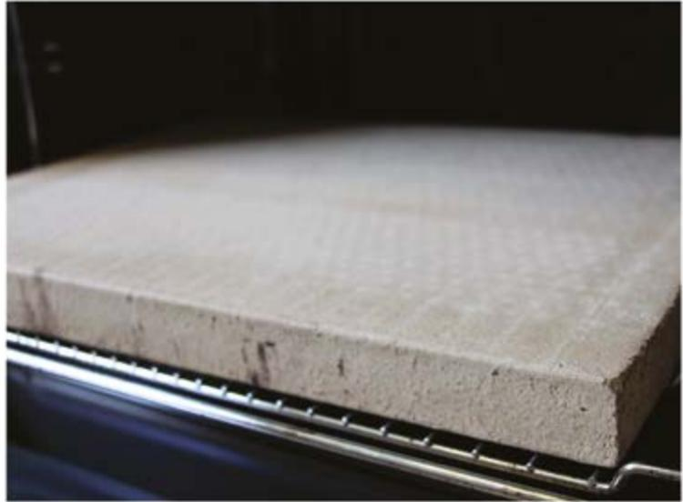
*Les pierres de chamotte sont poreuses et ont une surface légèrement rugueuse. Ceci permet qu'une couche d'air très fine se forme entre la surface chaude de la pierre et la pâte à pizza. Dans cette couche d'air, l'humidité excédentaire de la pâte s'évapore et est évacuée latéralement. Ainsi la pâte devient croustillante et la garniture reste juteuse.*
